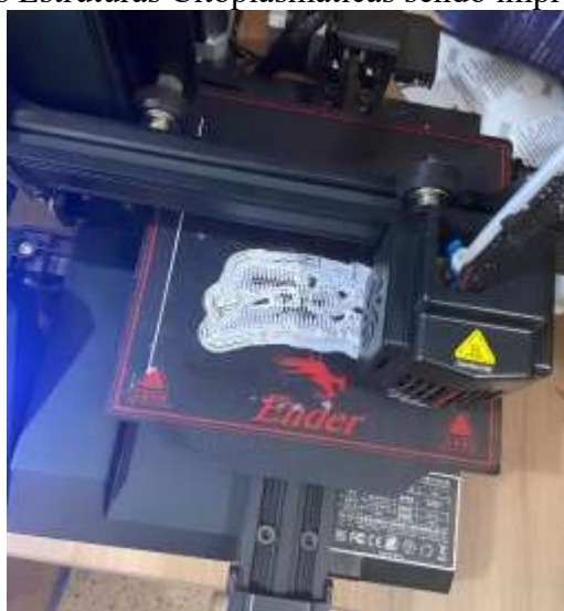
Figura 2 – Modelos das Estruturas Citoplasmáticas sendo impressos em 3D pelo FDM.
