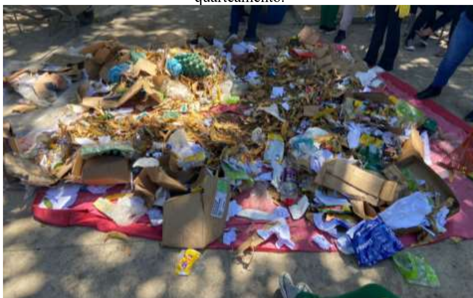
Imagem 4 – Segundo momento: Homogeneização da massa de resíduos para posterior quartejamento.
