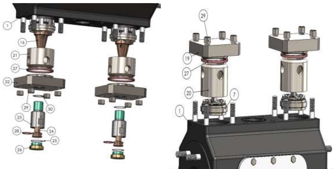
Figura 6 – Vista explodida do modelo proposto.
