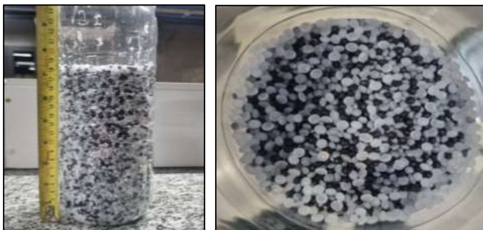
Imagem 11 – Refil (a): refil com a mistura finalizada; Refil (b): secção interna do refil, onde é possível visualizar o grau de homogeneização do ensaio
